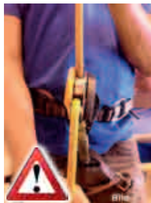
Fel inkopplad Grigri med endast den fasta sidoplåten i låskarbinen!
